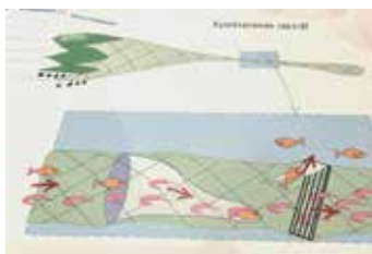
Genom en selekterande räktrål slipper man bifångst och fiskarna kan glada simma ut igen.
